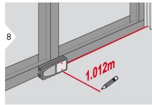
Медленно перемещайте прибор вдоль линии разметки. На дисплее отобразится расстояние до следующей точки разметки.
