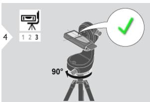
Поверните прибор по направлению движения часовой стрелки на  $90^\circ$ . Следуйте инструкциям на дисплее. Выравнивание завершено после появления иконки «OK» на дисплее.
