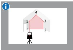
Площадь рассчитывается на основе нескольких известных координат с помощью значений x, у и z.
