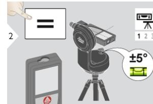
Для выполнения выравнивания диапазон наклона прибора должен составлять  $+/- 5^\circ$ .
